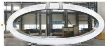
塔筒门框 Дверная рама башни
